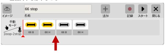
ブレーキマクロのブレーキ区間をオンにして、制動距離分をディレイさせる。 (仮想的にブレーキ区間を作り出す。ここの値で制動距離を調整できる)
